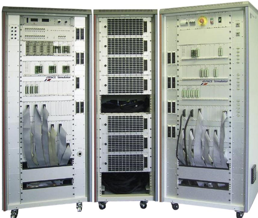
▲ Zwillings-simulatoren von dSPACE: Renault F1 in Großbritannien und in Frankreich testen gleichzeitig neue Funktionen auf dem Elektroniksystem Step 11 von Magneti Marelli.
