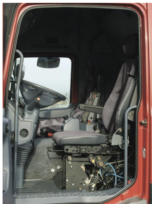
▲ Der Prototyp der aktiven Sitzfederung integriert in eine Fahrerkabine.
