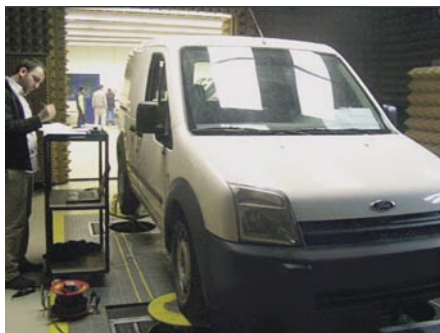
▲ Der Ford Transit Connect mit semiaktiver Dämpferregelung auf dem Fahrdynamikprüfstand.
