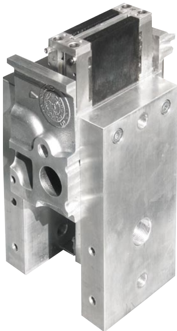
▲ Basis des Ventilprüfstandes ist ein Teil eines Serienzylinderkopfes. Mit Druckluft werden die am Ventil wirkenden Gaskräfte simuliert.
