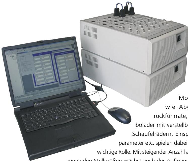
▲ *Modulares RCP-System mit Nutzfahrzeug-Sensor/Aktor-Interface des IAT.*
