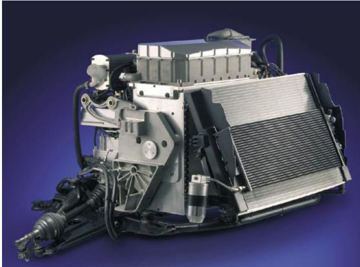
▲ Die Brennstoffzelle – das Kraftwerk unter der Motorhaube.
