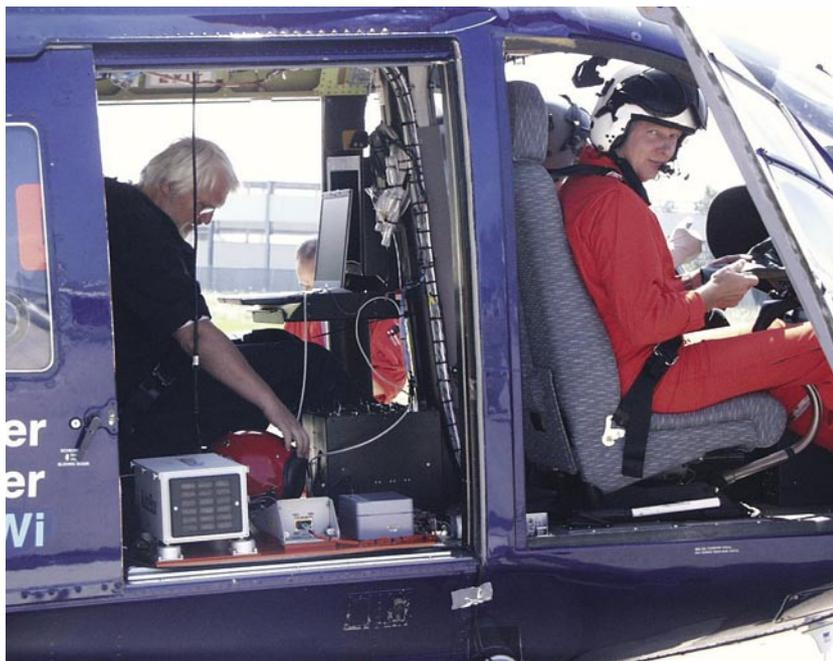
◀ Das dSPACE-Prototyping-System beim Einsatz im Helikopter. Es sorgt für gezielte Ausschläge zusätzlicher Klappen im Rotorblatt und minimiert dadurch den Fluglärm und die Vibrationen.
