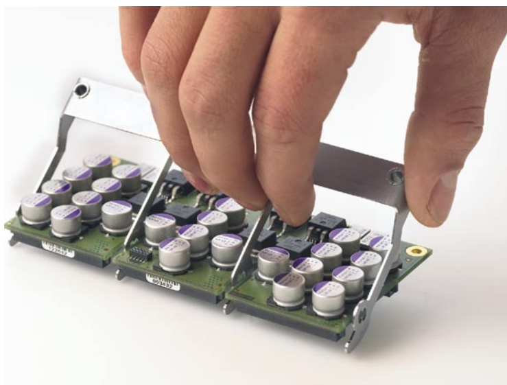
▲ Die Module können leicht in die RapidPro-Einheiten eingebaut und aus den ihnen entfernt werden.
