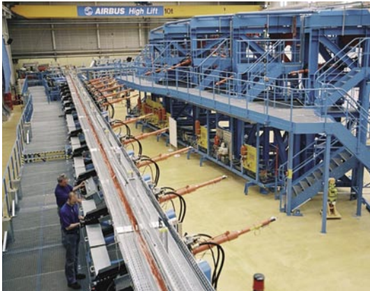
▲ Der High-Lift-Prüfstand zum Testen des Vorflügel- und Landeklappensystems. Die Luftlasten eines realen Fluges werden durch Hydraulikzylinder simuliert.
