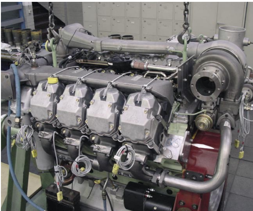
▲ Der Deutz TCD2015 V8 4V wiegt ca. 1280 kg und hat ein maximales Drehmoment von 3050 Nm.
