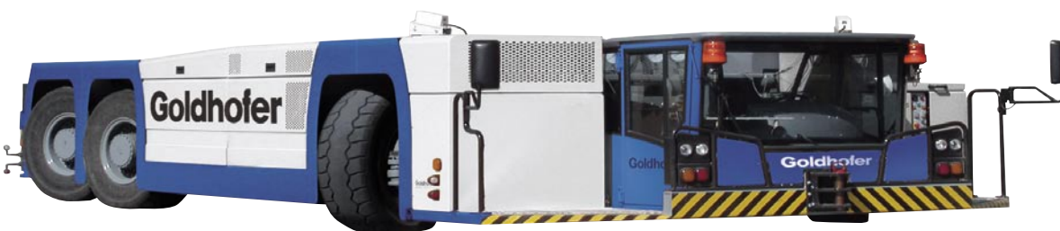
▲ Der mit zwei Deutz-Dieselmotoren ausgerüstete stangenlose Flugzeugschlepper AST-1X der Firma Goldhofer wurde für Kolosse wie den Airbus A380 entwickelt.
