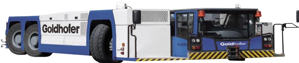
▲ Der mit zwei Deutz-Dieselmotoren ausgerüstete stangenlose Flugzeugschlepper AST-1X der Firma Goldhofer wurde für Kolosse wie den Airbus A380 entwickelt.
