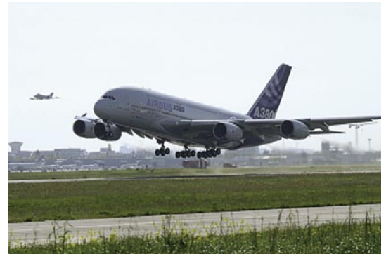
▲ Der Airbus A380 während der Landephase. Ausfahrbare Klappen an den Tragflächen erhöhen den Auftrieb und ermöglichen einen extremen Langsamflug.
