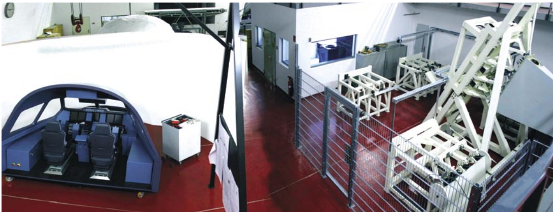
▲ Mit dem Prüfstand am DLR (Deutsches Zentrum für Luft- und Raumfahrt) lässt sich eine Vielzahl von Flugsituationen simulieren. Rechts im Bild die verschiedenen Ruderflächen, links das Cockpit vor der Projektionswand.
