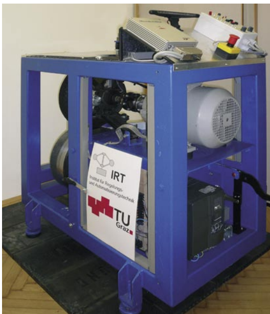
▲ Aufbau des Prüfstands mit MicroAutoBox und Bedienkonsole.
