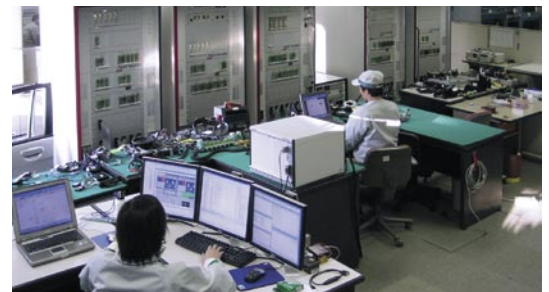
▲ Ansicht des im Labor aufgebauten Virtual-Vehicle-Testsystems.
