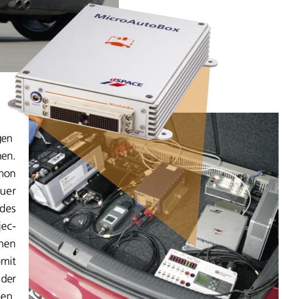
▲ Die MicroAutoBox wurde im Kofferraum des Testfahrzeugs verbaut.
