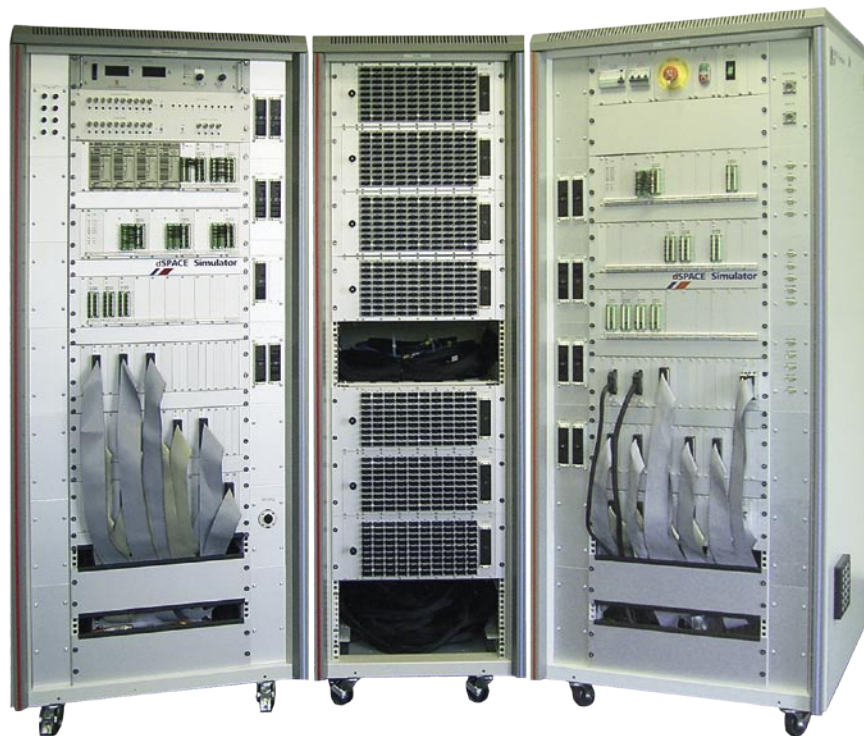
▲ Zwillingsimulatoren von dSPACE: Renault F1 in Großbritannien und in Frankreich testen gleichzeitig neue Funktionen auf dem Elektroniksystem Step 11 von Magneti Marelli.
