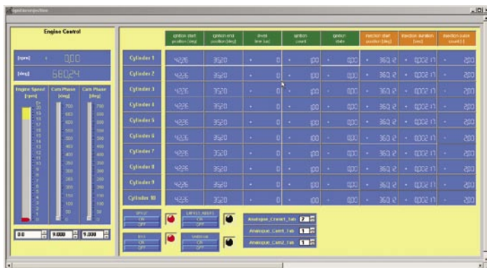
▲ Der ControlDesk-Screenshot zeigt die Validierung des Zünd- und Einspritztimings.
