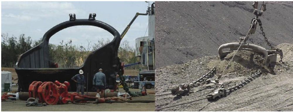
▲ Der Schürfkübel zum Erfassen des Abraumes: 40 Tonnen Leergewicht, 120 Tonnen mit Inhalt.
