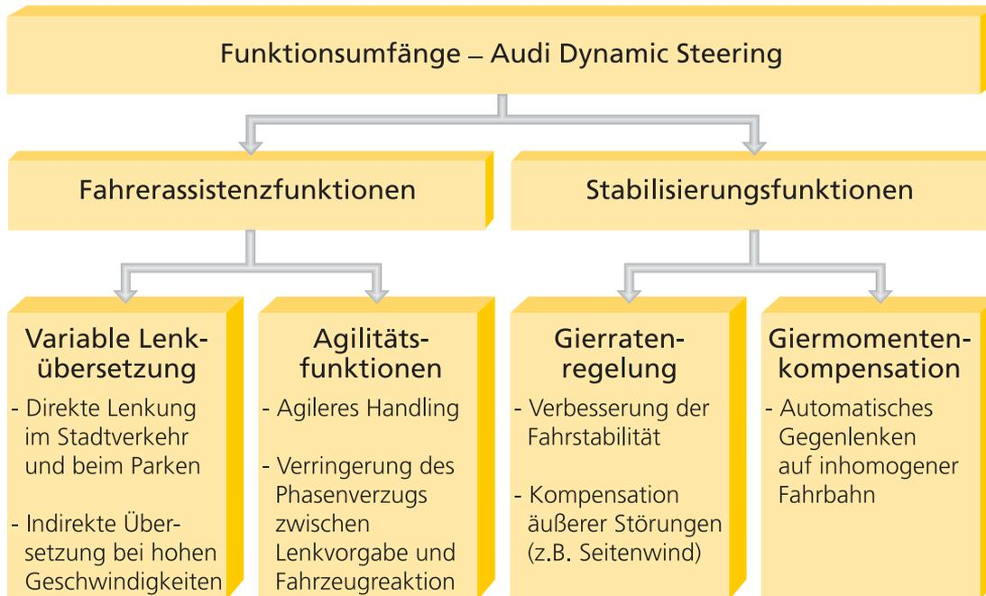
▲ Funktionsumfänge von Audi Dynamic Steering. Das Lenksystem ermöglicht mit seinen Funktionen sowohl ein sportlicheres Fahrverhalten als auch mehr Fahrzeugsicherheit in Grenzsituationen.
