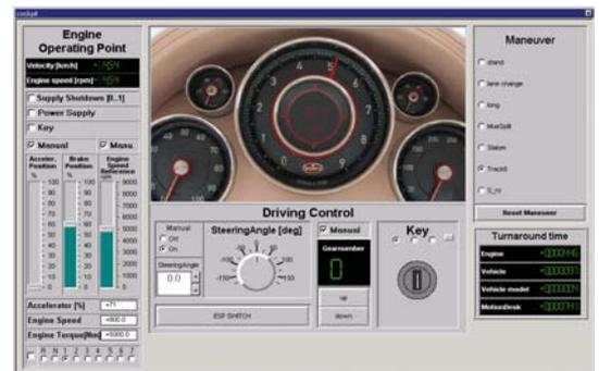
▲ Über die ControlDesk-Benutzeroberfläche werden mit der fotorealistischen Instrumententafel die Tests durchgeführt.
