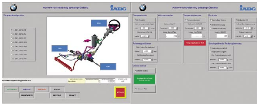
▲ Interaktive Benutzeroberfläche zur Steuerung des Prüfstands.
