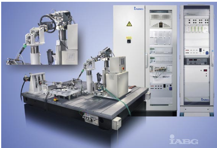
▲ Der HIL-Prüfstand zum Test von Aktivlenkungen hat sich als ein effektives Werkzeug bewährt.
