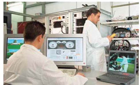
▲ Virtuelles Fahrzeug von ELASIS: Die vernetzten Simulatoren werden von einem zentralen PC gesteuert.
