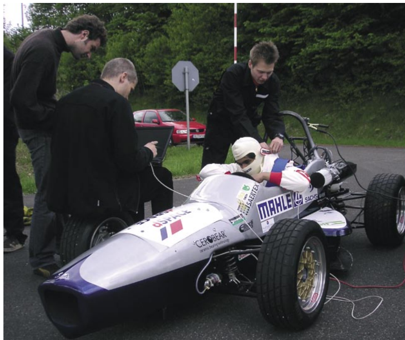
◀ Mit Hilfe des Flight Recorders der MicroAutoBox wurden während der Straßentests Daten erfasst, um sie später auszuwerten. So wurden Fehler im Reglermodell aufgedeckt.
