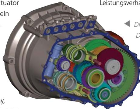
◀ Die Mechanik des Doppelkupplungsgetriebes ermöglicht den Übergang zwischen zwei Übersetzungsverhältnissen ohne Verlust der Zugkraft.
