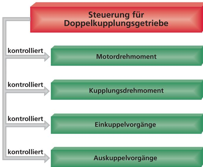
▲ Vier zentrale Abläufe werden durch das Regelsystem des Doppelkupplungsgetriebes gesteuert. Der Fahrkomfort während des Schaltens wird beträchtlich erhöht und der Gangwechsel bei Wendemanövern wird sicherer.
