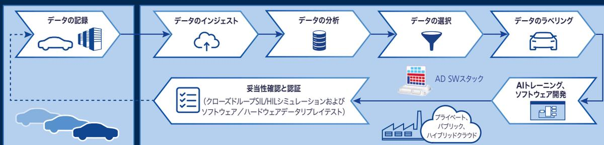
図 1: データドリブン開発のデータパイプラインとサイクル (簡略図)
