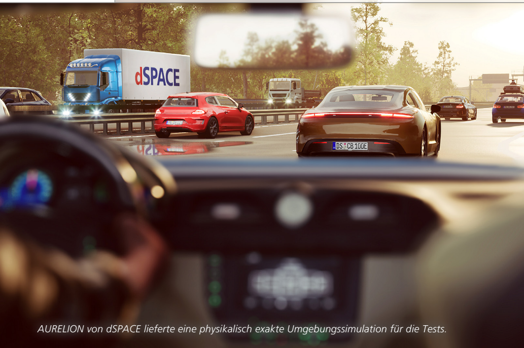
Automotive Simulation Models (ASM) wurden verwendet, um realistische Verkehrsszenarien hinzuzufügen und die virtuelle Welt mit Fahrzeugen zu füllen, die von den Radar-, Kamera- und Lidarsensoren erfasst werden können.
