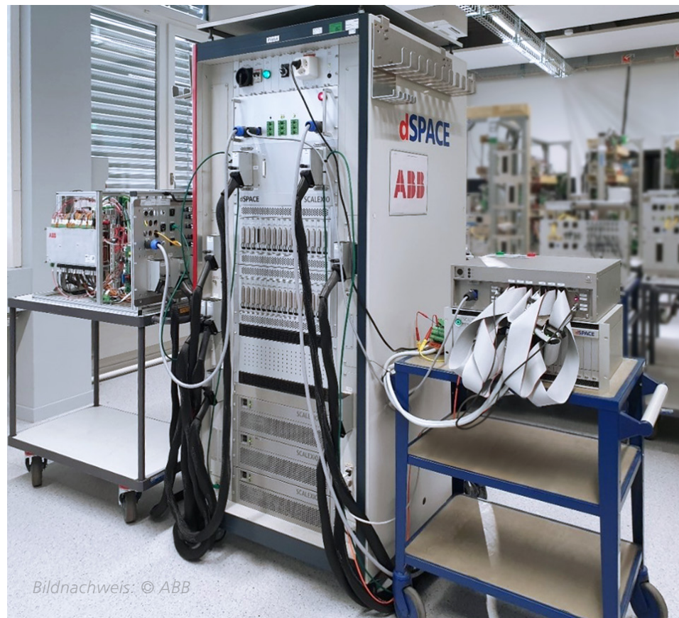
Abbildung 3: ABB Traction Simulator mit dSPACE SCALEXIO-Systemen für die kombinierte Simulation von Traktionsumrichtern und Hilfsbetriebeumrichtern.
