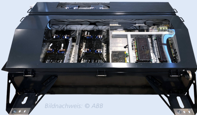
Abbildung 2: ABB-Traktionsumrichter mit integriertem Hilfsbetriebeumrichter.
