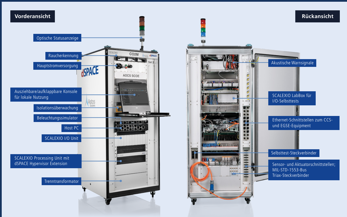
Abbildung 3: Aufbau des für das AOCS SCOE verwendeten dSPACE SCALEXIO-Systems. Für jeden der Satelliten wird ein eigenes AOCS SCOE gebaut.
