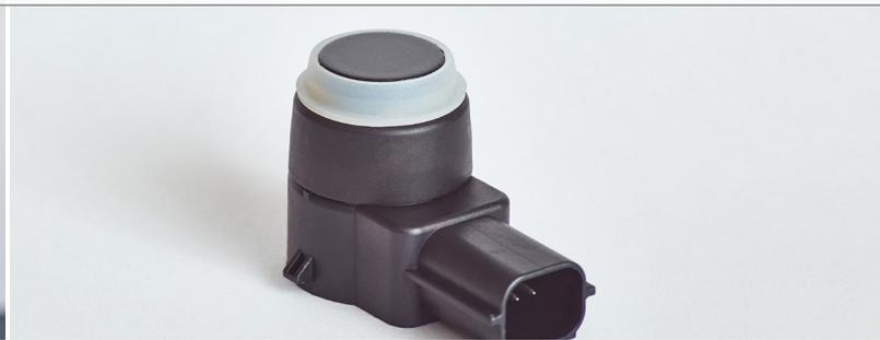
flektor, der ebenfalls mit dem Simulator verbunden ist, wird gegenüber von jedem USS positioniert. Er empfängt die Signale der USS und sendet diese abhängig von der sich aus der Simulation ergebenden Entfernung zeitverzögert zurück. So werden die USS vollständig per Simulation stimuliert und liefern die von ihnen ermittelten Entfernungssignale an das Assistenzsystem. Parkassistenten, die ausschließlich mit USS aufgebaut sind, lassen sich mit diesem Aufbau vollständig testen und absichern.
