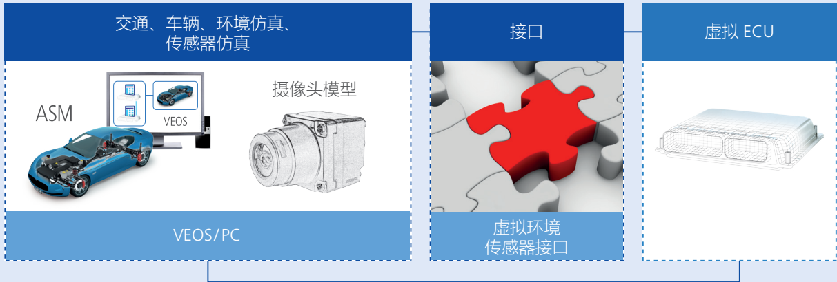
在 SIL 仿真中，车辆、环境和传感器模型与虚拟 ECU 一起形成控制回路。
