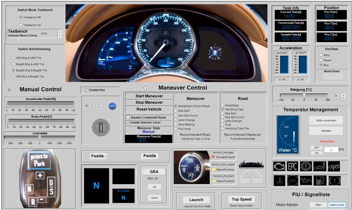
Die Experimentiersoftware ControlDesk schickt die simulierten Fahrzeuge von Bugatti auf virtuelle Testfahrten.
