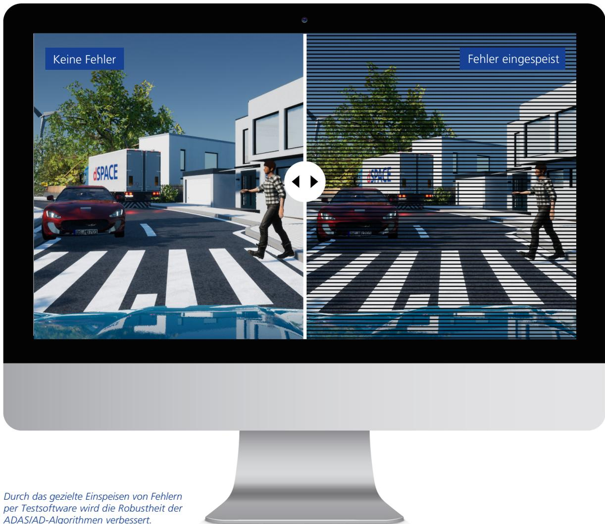
*Durch das gezielte Einspeisen von Fehlern per Testsoftware wird die Robustheit der ADAS/AD-Algorithmen verbessert.*
