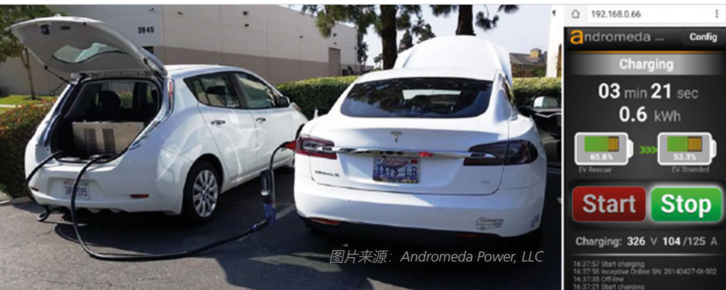
图 1: 日产聆风通过导电充电电缆将电能传输到特斯拉Model S。移动APP与两辆车进行通信, 让驾驶员控制充电过程。
