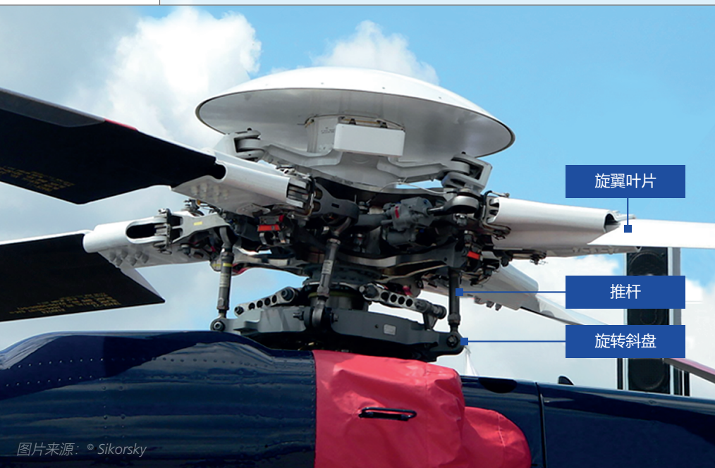
图 1: Sikorsky S-92旋翼头和传统控制系统。液压伺服系统 (不可见) 位于旋转斜盘下方。
