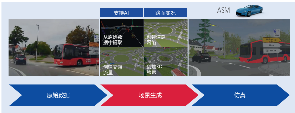
图 2：用于仿真的场景是通过dSPACE和understand.ai的解决方案根据采集的测量数据生成的。
