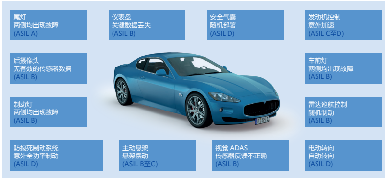
图 2: 根据汽车安全完整性等级 (ASIL) 的典型分类。ASIL 是 ISO 26262 标准的关键组成部分。ASIL 是在每个开发流程的开始阶段确定的。对系统功能进行分析, 并将其与可能的风险联系起来。
