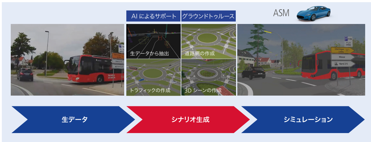
図2：dSPACE および understand.ai 社のソリューションを使用して、取得した計測データからシミュレーション用のシナリオを生成
