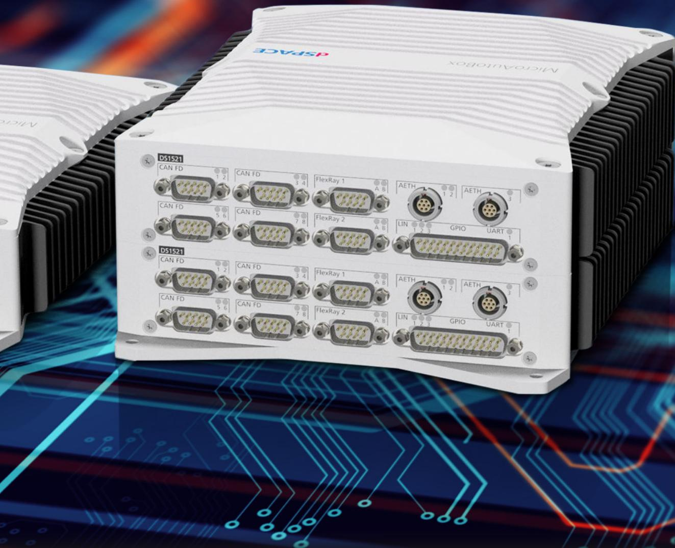
MicroAutoBox III では、さらに幅広いバスおよびネットワークインターフェースを搭載した各種のバリエーションが新たに追加されており、MicroAutoBox の製品ラインの一層の多様化および強化を実現しています。また、新しい DS1521 Bus and Network Board を搭載した MicroAutoBox III では、慣れ親しんだ MicroAutoBox のコンパクトな筐体の中に格段に豊富な種類のチャンネルが実装されています。
