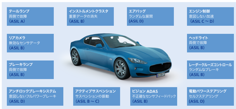
図 2：Automotive Safety Integrity Level (ASIL) に基づく一般的な分類。ASIL は ISO 26262 規格の重要な要素です。ASIL は、各開発プロセスの開始時点で決定されます。システムの各機能は、発生し得るリスクとの関連に基づいて分析および評価されます。
