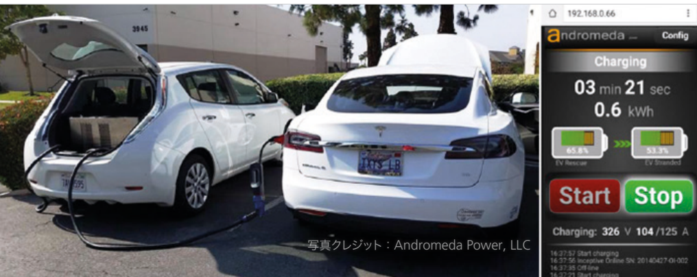
図 1: 充電ケーブルを使用して、日産 Leaf から Tesla Model S にエネルギーを伝送します。ドライバーが充電プロセスを制御できるよう、モバイルアプリで両方の車両と通信します。
