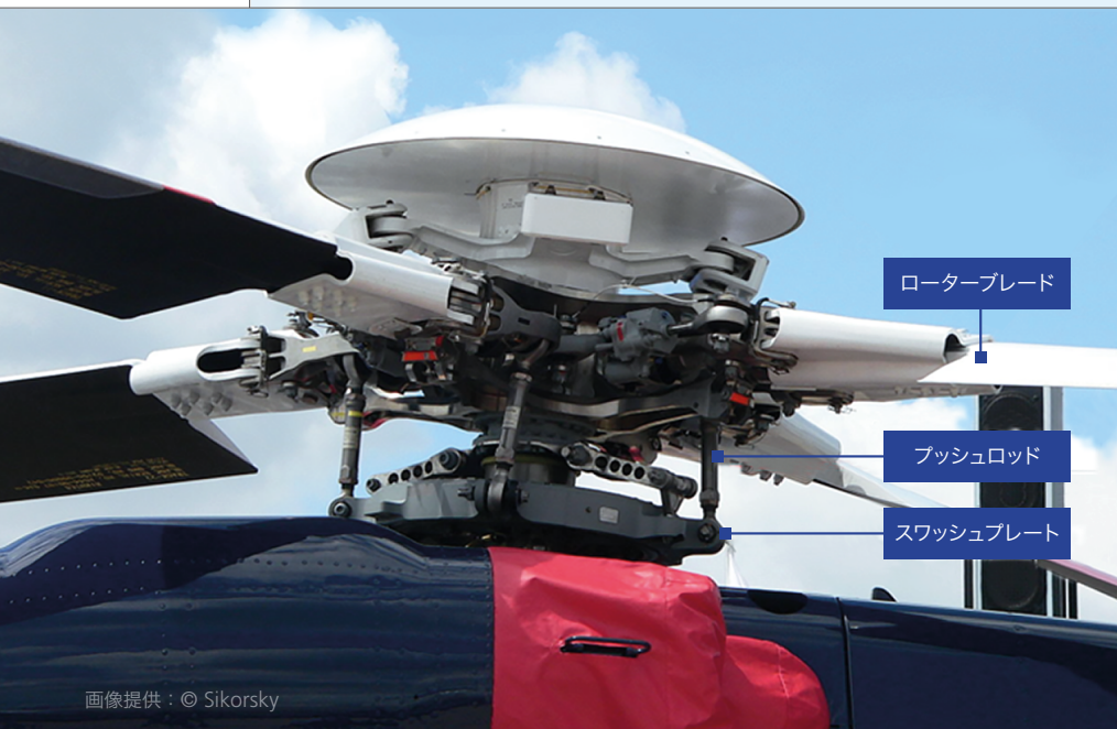
図1：従来型の制御システムを搭載した Sikorsky S-92 ローターヘッド。油圧サーボ（視認不可）はスワッシュプレート下部にあります。
