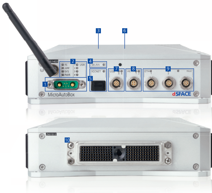
图 1: 设计紧凑, 所有接口均与汽车应用相关 – 新型 MicroAutoBox III (此处为: MicroAutoBox III 1403/1511)。
