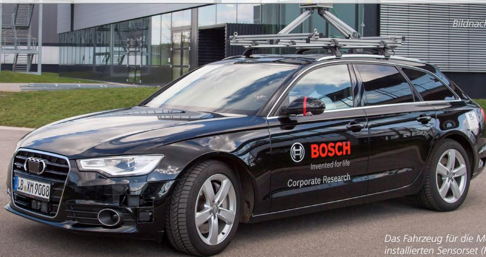
Das Fahrzeug für die Messkampagne mit dem installierten Sensorset (Radar, Lidar, Kamera).
