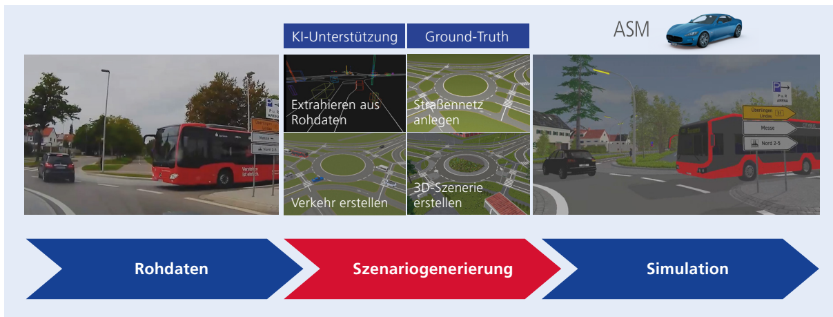
Abbildung 2: Aus den erfassten Messdaten wird mit Hilfe der Lösung von dSPACE und understand.ai ein Szenario für die Simulation generiert.
