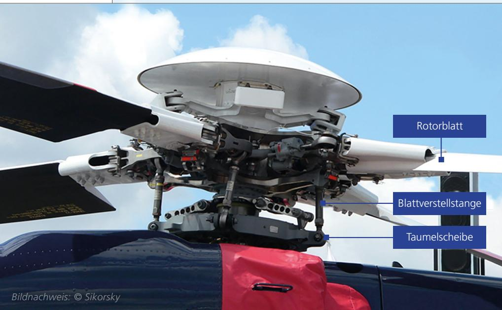
Abbildung 1: Rotorkopf des Sikorsky S-92 mit traditionellem Steuerungssystem. Die Hydraulikservos (nicht sichtbar) befinden sich unterhalb der Taumelscheibe.
