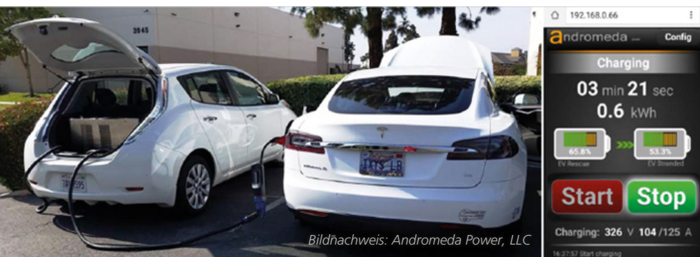
Abbildung 1: Ein Nissan Leaf überträgt per Ladekabel Strom an einen Tesla Model S. Der Fahrer steuert den Ladevorgang über eine mobile App, die mit beiden Fahrzeugen kommuniziert.
