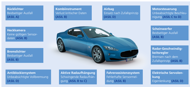
Abbildung 2: Typische Klassifikationen nach Automotive Safety Integrity Level (ASIL). ASIL ist eine Schlüsselkomponente des Standards ISO 26262. Der ASIL-Level wird jeweils zu Beginn eines Entwicklungsprozesses bestimmt. Dabei werden die Systemfunktionen analysiert und in Bezug zu möglichen Risiken gestellt.
