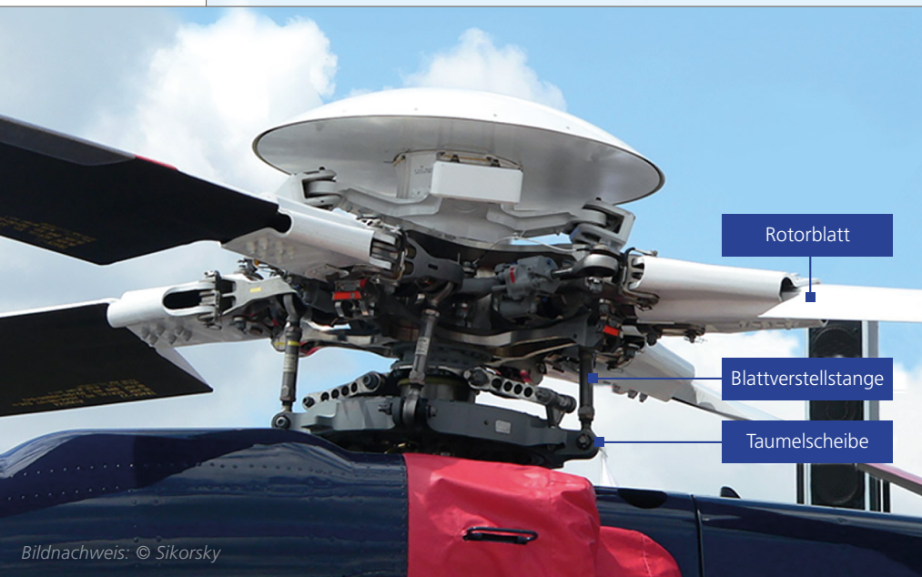
Abbildung 1: Rotorkopf des Sikorsky S-92 mit traditionellem Steuerungssystem. Die Hydraulikservos (nicht sichtbar) befinden sich unterhalb der Taumelscheibe.
