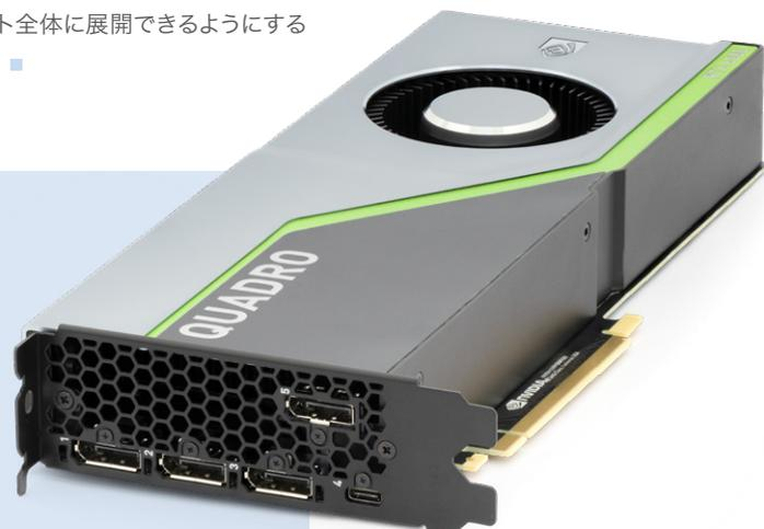
センサーデータのプリプロセッシングを行う場合は、AUTERA に NVIDIA Quadro RTX 6000 などの強力なグラフィックカードを搭載することができます。
