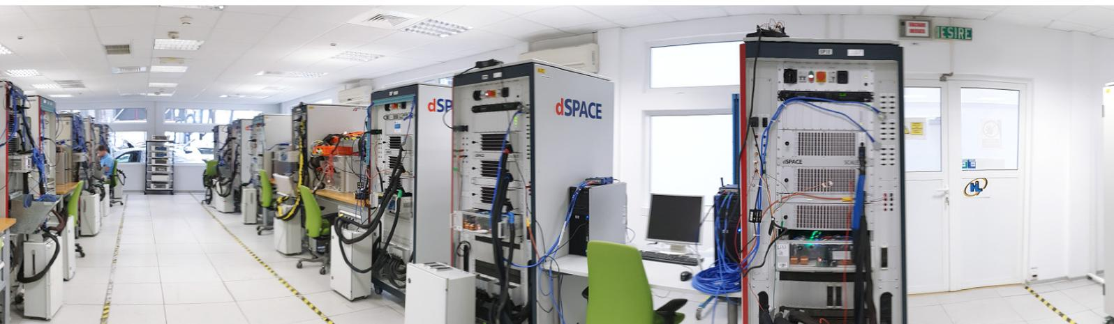
Renault 社では、新しいパワートレイン用制御ユニットのテストに対応するため、13 個の SCALEXIO システムと 21 個の PHS ベースのシステムを組み込んだテスト工場をルーマニアに設立しました。これにより、同社の妥当性確認チームのメンバーは、それぞれ自身のテスト目的に合わせてテストシステムを予約できるようになりました。
