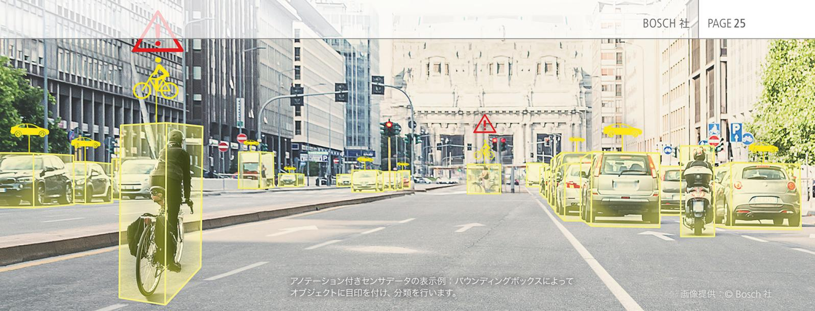
アノテーション付きセンサデータの表示例：バウンディングボックスによってオブジェクトに目印を付け、分類を行います。
