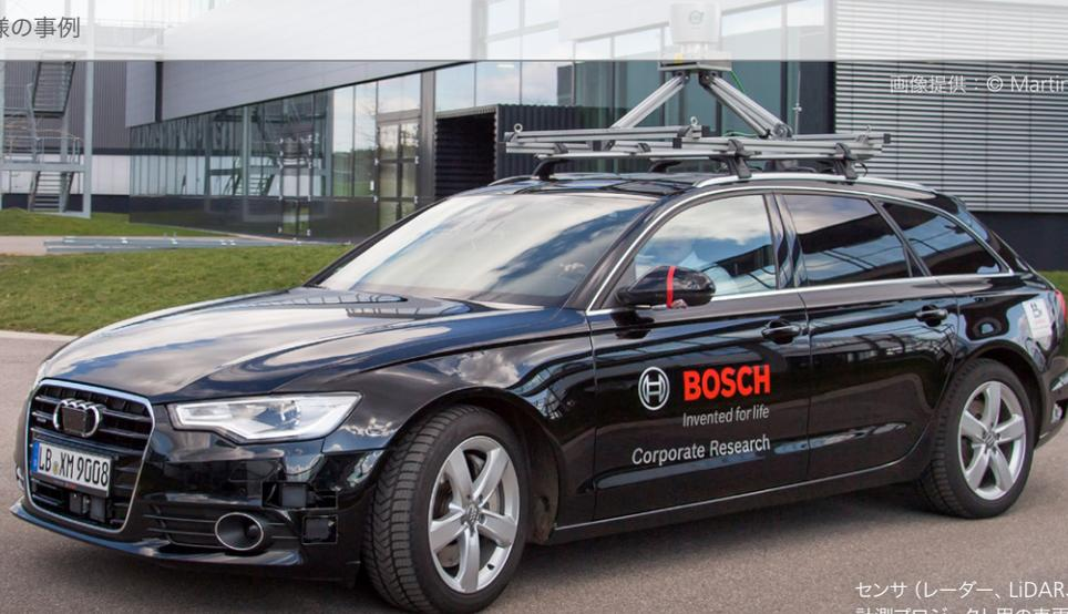
センサ（レーダー、LiDAR、カメラ）を取り付けた計測プロジェクト用の車両
