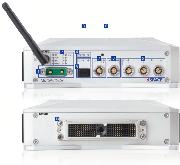
Abbildung 1: Kompaktes Design mit allen relevanten Schnittstellen für automotive Anwendungen – die neue MicroAutoBox III (hier die Variante MicroAutoBox III 1403/1511).
