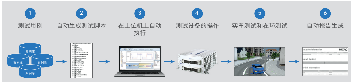
图 3: 根据 SOTIF 标准进行自动测试的典型流程。自动生成测试脚本以及可以使用相同工具执行 HIL 测试和真实驾驶测试是这种方法的主要优势。
