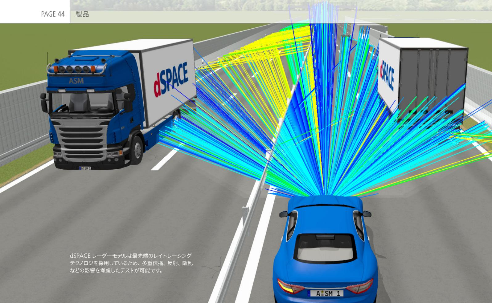
dSPACE レーダーモデルは最先端のレイトレーシングテクノロジーを採用しているため、多重伝播、反射、散乱などの影響を考慮したテストが可能です。
