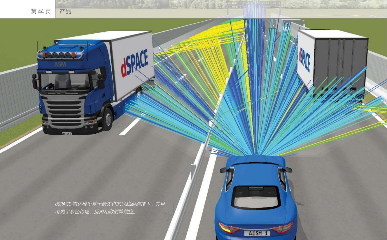
利用 Sensor Simulation 中的光线跟踪引擎，按照物理精度仿真毫米波和红外辐射的传播，这是激励和仿真雷达和激光雷达传感器的基本功能。
