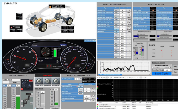
図 4 : 試験ソフトウェアである ControlDesk の各種計器を使用して使いやすいインターフェースを設計できたため、すべてのプロセスを現実に即して容易にシミュレートすることができました。
