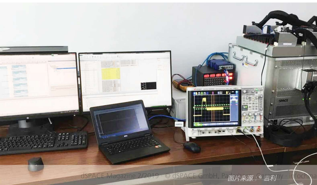
图 2：dSPACE 测试台架由一个 SCALEXIO 仿真器和一个驱动器负载箱组成。紧凑型系统占地面积小，易于通过上位机操作。并且信号用示波器测量。
