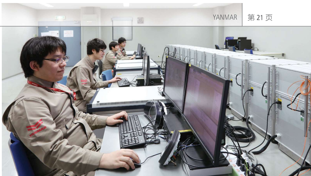
一套标准化处理器/电源机架和主 I/O 机架
