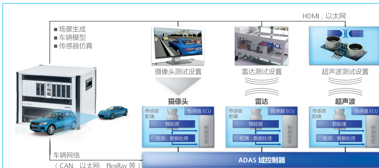
图 5：各种环境传感器的 OTA 激励原理。
