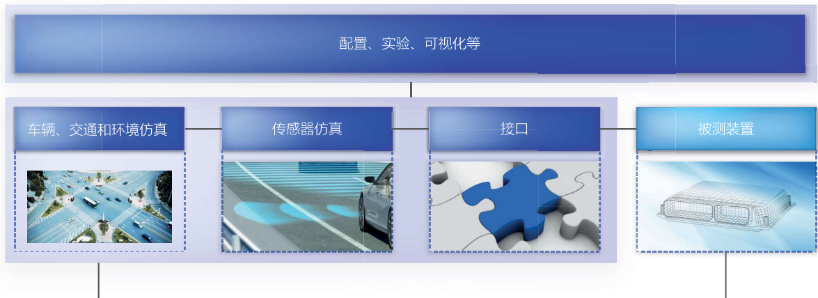
图 1：ADAS 和 AD 功能仿真环境的基础结构。借助标准 PC 技术 (MIL/SIL) 或通过添加实际控制单元 (HIL)，可以进行纯虚拟仿真。
