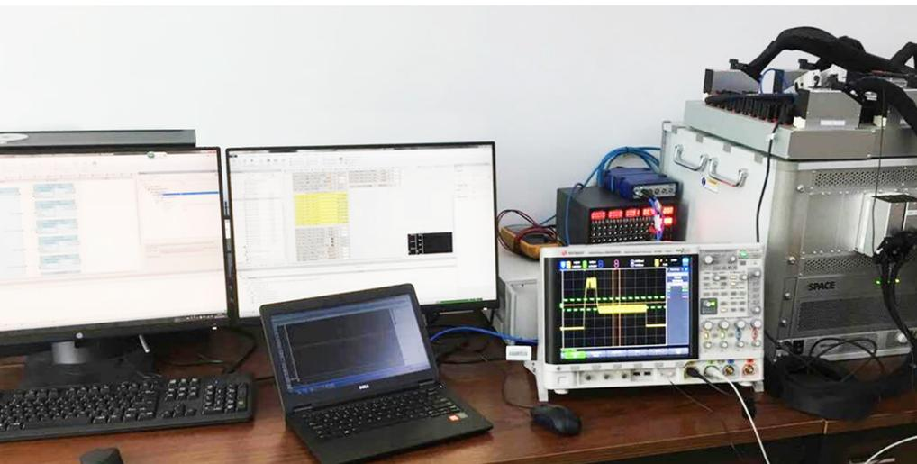
ムプラットフォームおよび Automotive Simulation Models (ASM) ツールスイートを採用しました。SCALEXIOシステムは、小型でありながらも幅広い入出力機能と高い計算能力を備えています(図2)。また、個別のアクチュエータを実負荷として組み込んでシミュレーションを行うことが可能です。
