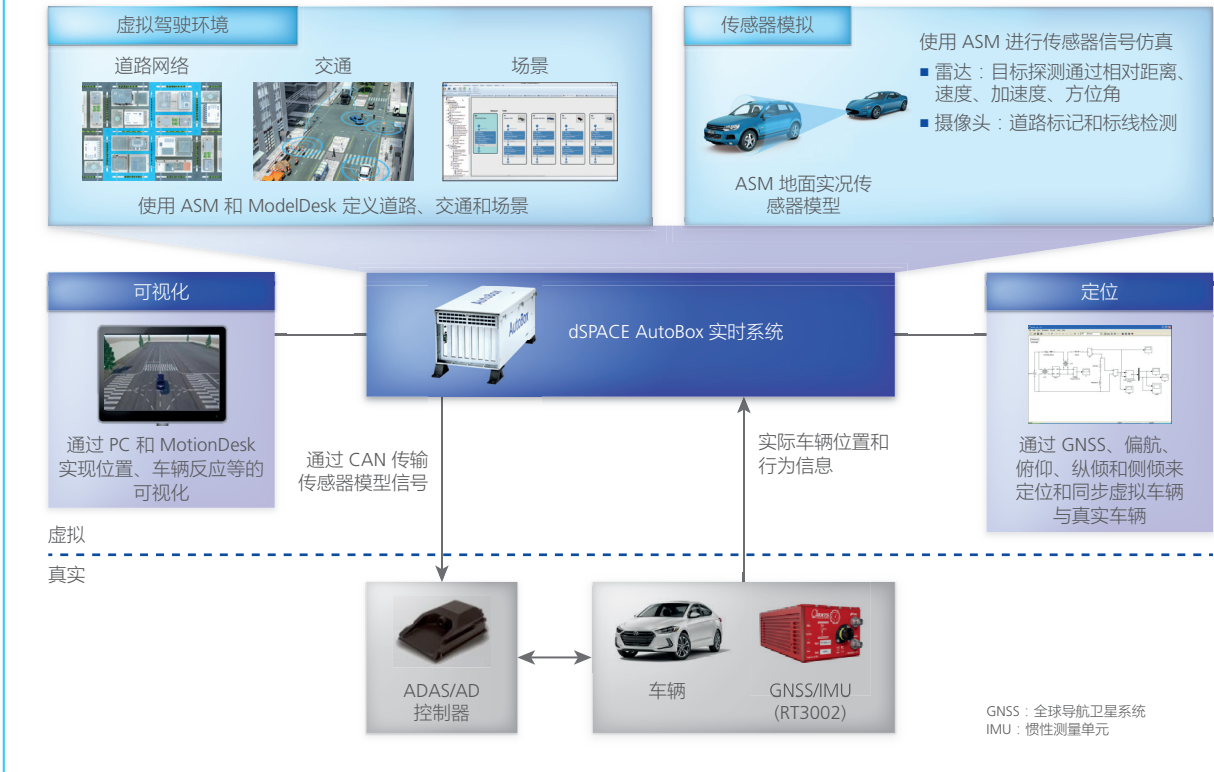
用于虚拟-真实验证的车辆在环 (VIL) 系统的设置。
