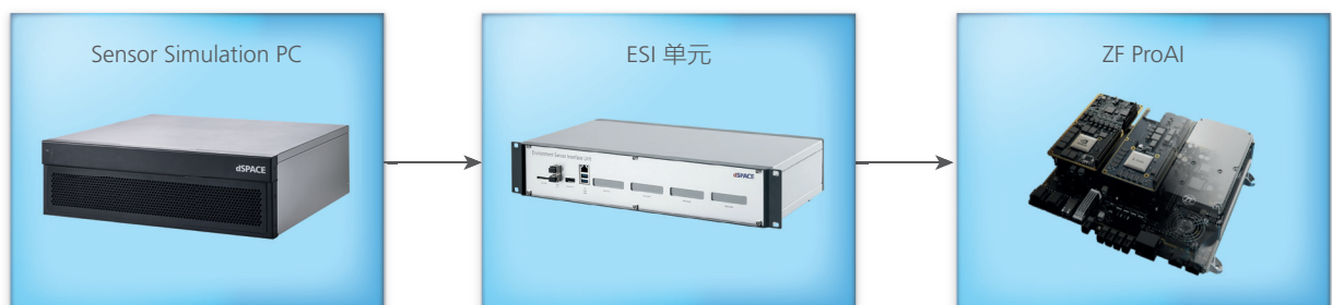
传感器仿真平台: 传感器数据在 Sensor Simulation PC 上进行仿真。Environment Sensor Interface Unit (ESI 单元) 能够像真实传感器那样提供电子信号。
