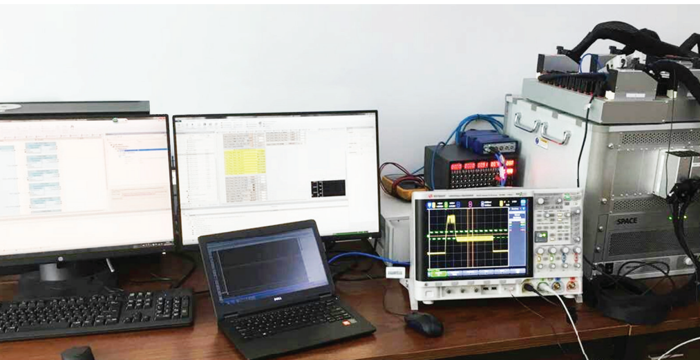
图 2：dSPACE 测试台架由一个 SCALEXIO 仿真器和一个驱动器负载箱组成。紧凑型系统占地面积小，易于通过上位机操作。并且信号用示波器测量。
